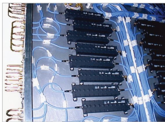
図4 受信ユニット内のフィルタ配置
