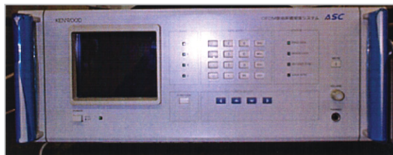
図5 OFDM信号評価受信システム
