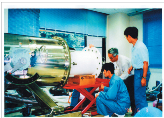
図4 SQUID装置は水平方向に挿入する
