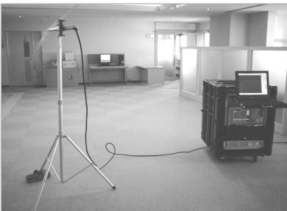
図 12 アンテナを用いた傍受実験環境 (対象との距離は 4m)
