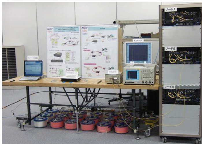
図4 光ゲートウェイを用いたネットワークテストベッド
