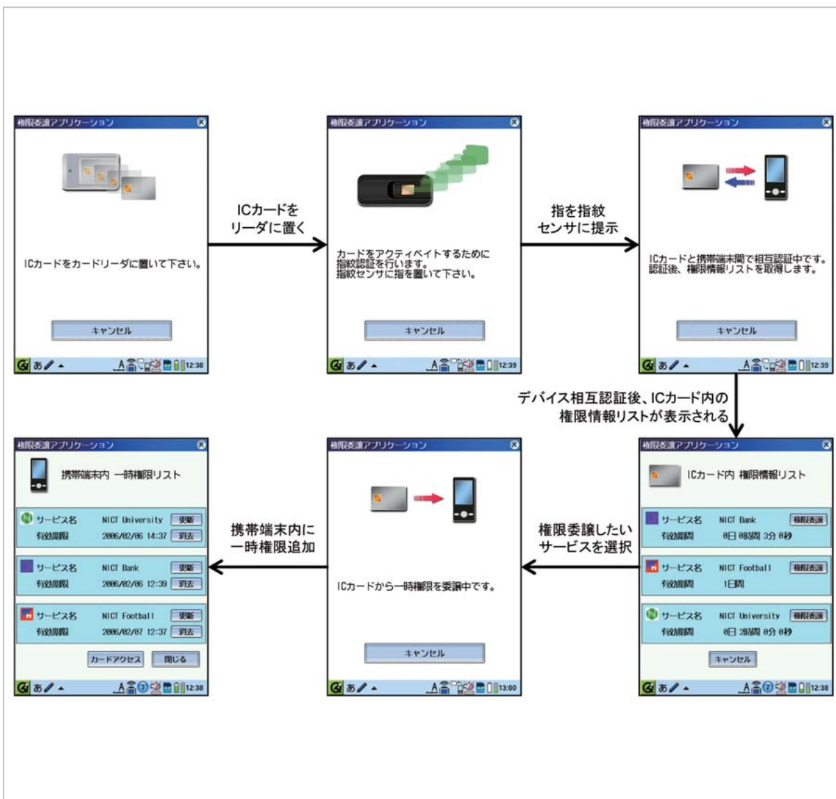
図6 権限委譲アプリケーション GUI 画面遷移例 (携帯端末上)
