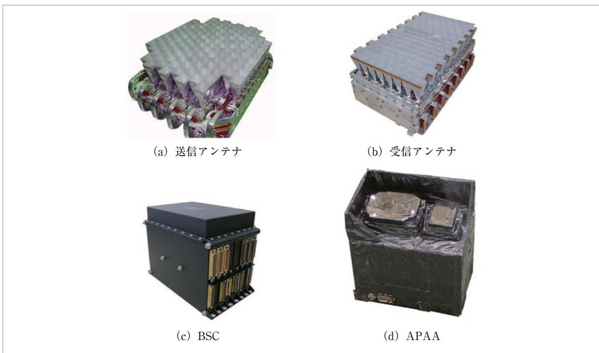
図6 送信アンテナ、受信アンテナ、BSC、APAA のPFM 外観写真
