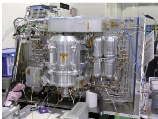
図5 性能試験中のSMILESサブミリ波受信機
