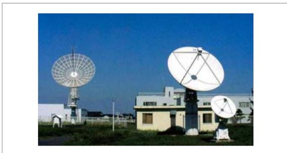
図 10 HIRAS システムの 10 m アンテナ (左奥)、6 m アンテナ (右奥) と 2.8 GHz 固定周波観測アンテナ (右手前)
