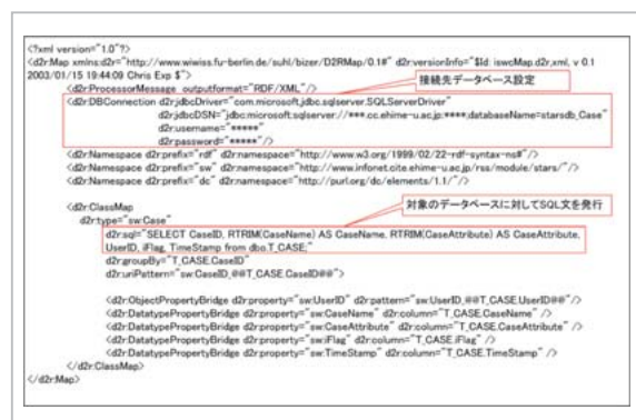
図15 表3の STARS イベント情報を RDF 変換するための D2R 設定ファイル(XML 形式)
