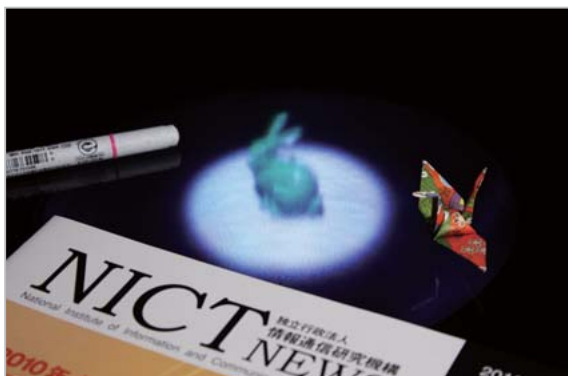
図2 テーブル型 3D ディスプレイ「fVisiOn」
