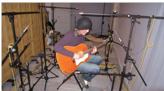
図4 マイクロホンの球形配置の写真
