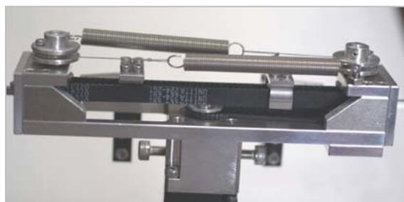
図 26 歯付ベルトに改良中の試作 3 号機
