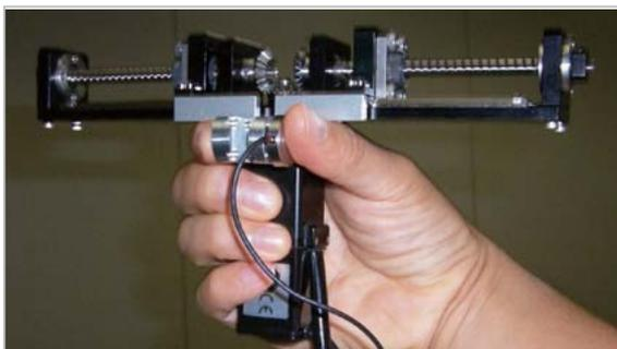
図 13 携帯型力覚デバイスの試作 1 号機の把持部分
