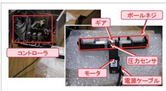
図 14 試作 1 号機の構成
