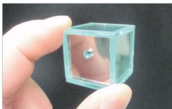
図2 超小型香り噴射装置「マイクロ・アロマ・シューター」
