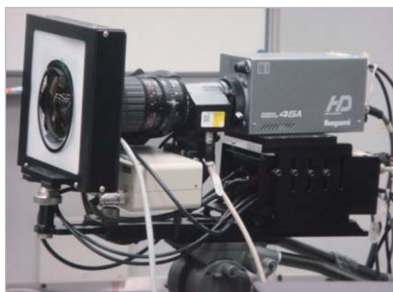
図 4 測距カメラ(Axi-Vision カメラ)
