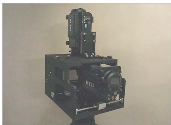
図 1 超高精細ステレオ 3D コンテンツ撮影カメラ
