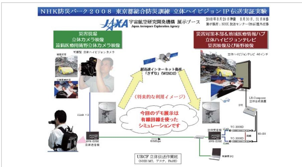
図5 東京都総合防災訓練での実験構成図
