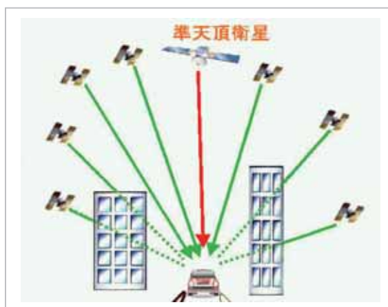
図1 準天頂衛星によるGPS補完
