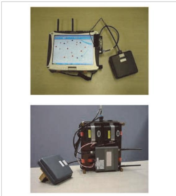
図6 ハイブリッドRFIDリーダライタユニット (表面:GISとパッシブタグリーダライタ、裏面:アクティブタグ受信機)
