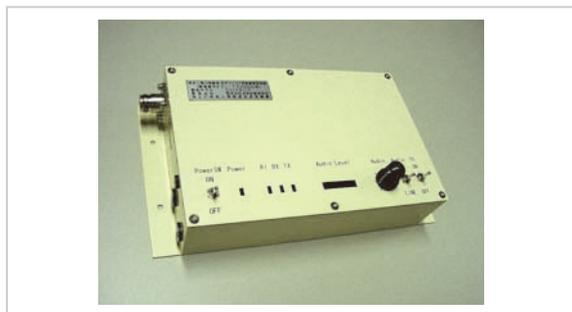
図145 試作した音声アシスト用無線電話装置
