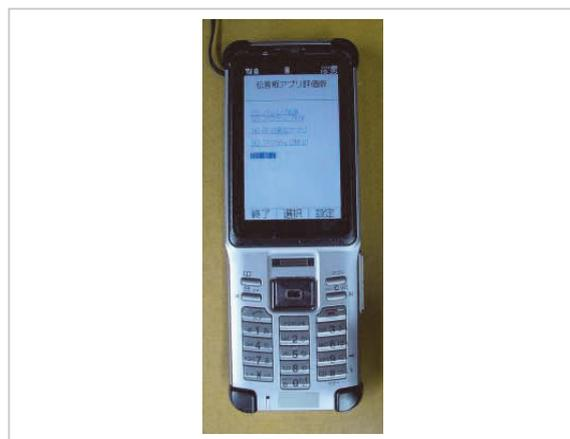
図 130 UHF 帯パッシブ/アクティブ RFID リーダライタ内蔵ユビキタス端末上で動作する伝言板アプリケーションの画面
