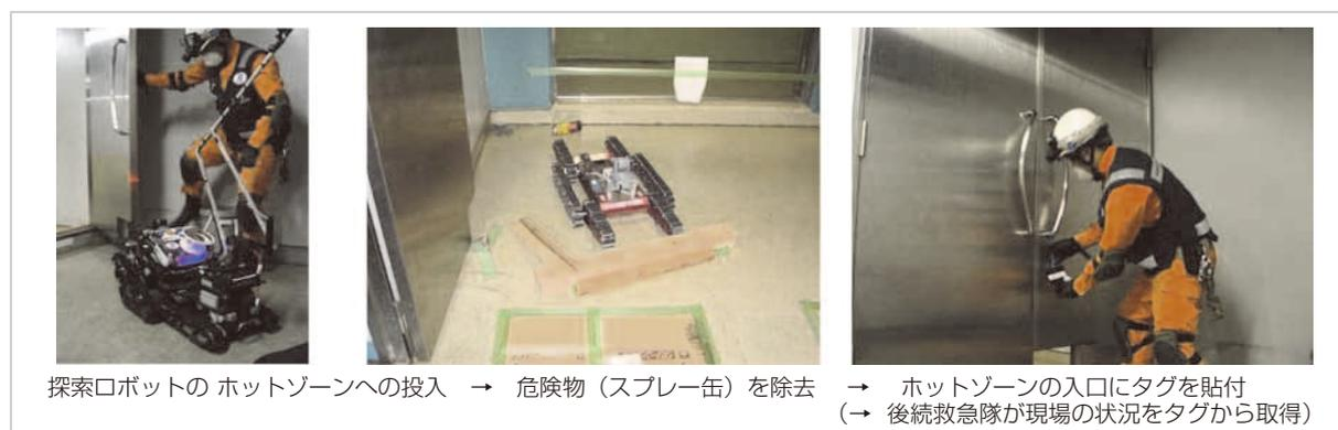
探索ロボットのホットゾーンへの投入 → 危険物(スプレー缶)を除去 → ホットゾーンの入口にタグを貼付
