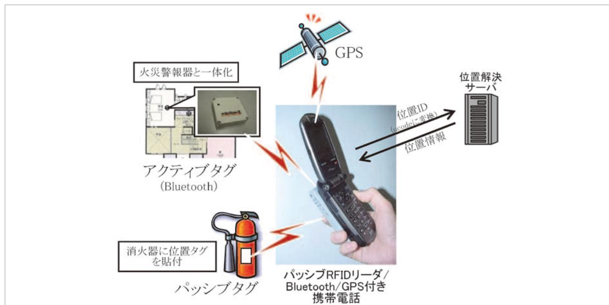
図 140 パッシブ RFID, Bluetooth タグ及び GPS による 3 ウェイ測位が可能な携帯電話アプリケーション
