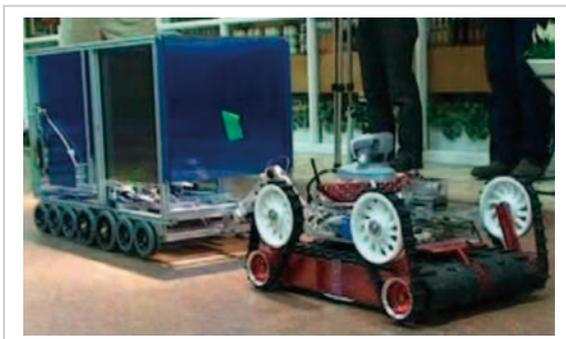
図17 トレーラ型ケーブル敷設システム
