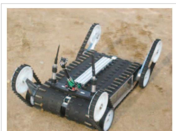
図 33 NEDO プロジェクトのロボット実用機 “Quince” に取り付けられた改良版防水・防塵アンテナ台
