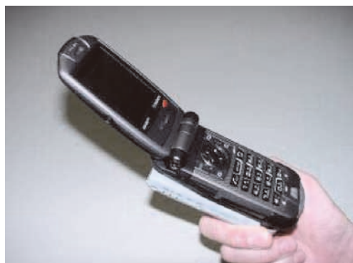
図11 パッシブRFIDリーダアタッチメントを取り付けた携帯電話端末 (au E03CA)
