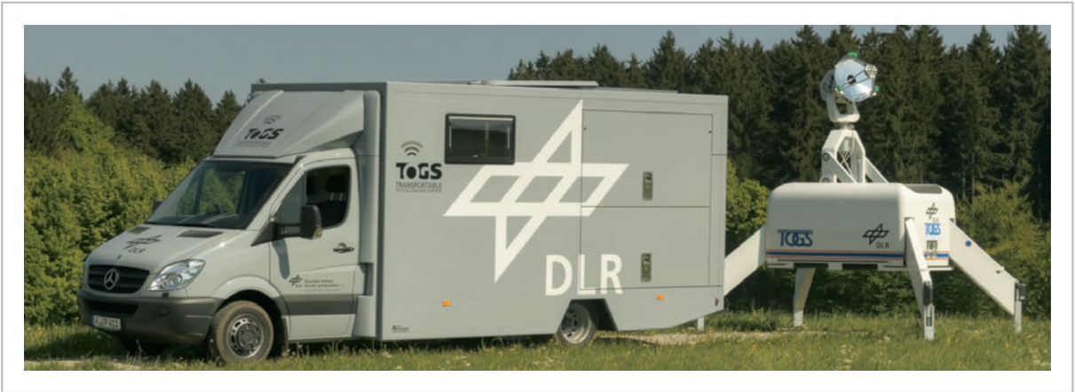
図9 衛星と航空機ダウンリンク用 DLR の搬送車の付いた可搬型光学地上局
