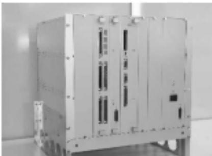
図1 搭載用ATM交換機BBM
