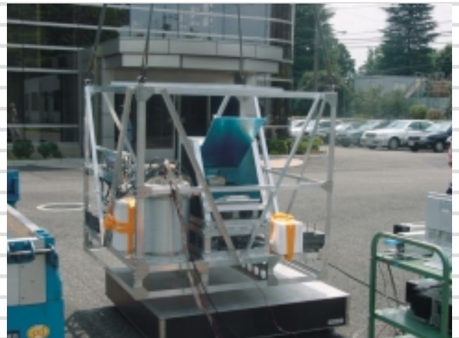
高高度気球搭載サブミリ波リム放射サウンダの ゴンドラ吊下げバランス試験
