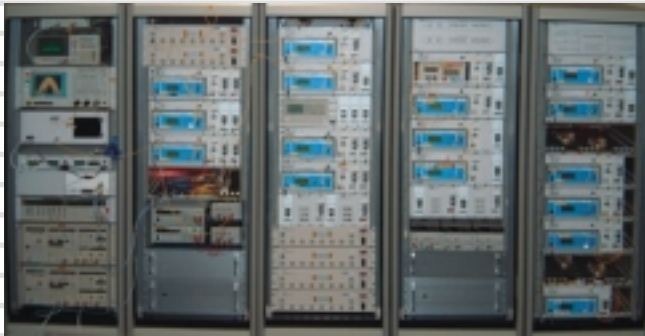
世界初の光宛先検索機能を備えた 光パケットスイッチプロトタイプ
