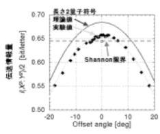
図1 超加法的量子符号化利得 単一光子の信号帯域を2倍にした 時、2倍以上の情報量を伝送
