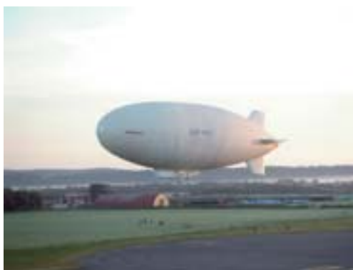
全長68mの定点滞空試験機 (宇宙航空研究開発機構)
