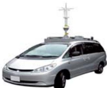
電磁界 3 軸同時モニタリング装置を搭載した測定車
