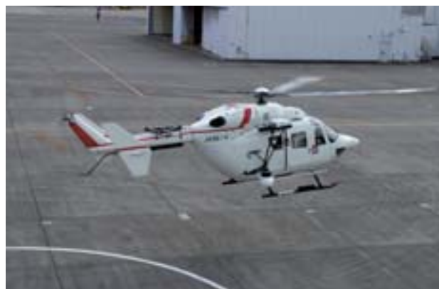
妨害・防災情報のための衛星デジタル伝送技術 (ヘリコプター衛星通信システム) [飛行試験]
