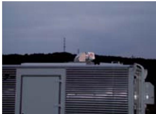
地上観測コヒーレント ドップラーライダー用コンテナの上に見える 2 軸スキャナー
