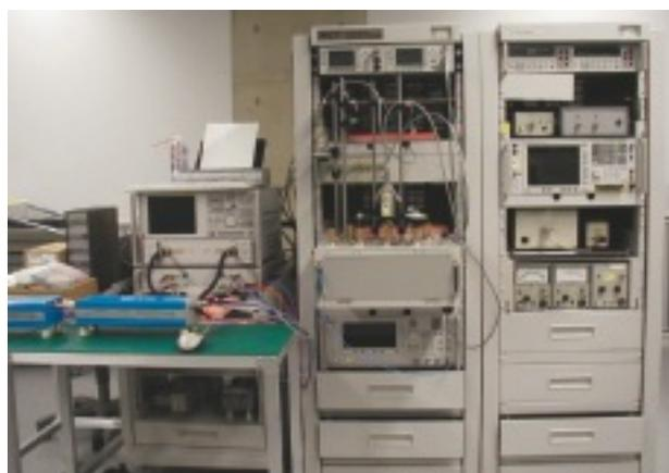
図2 50GHz帯電力較正システム
