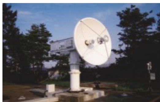
測地VLBIに成功した小型(2.4m)アンテナ
