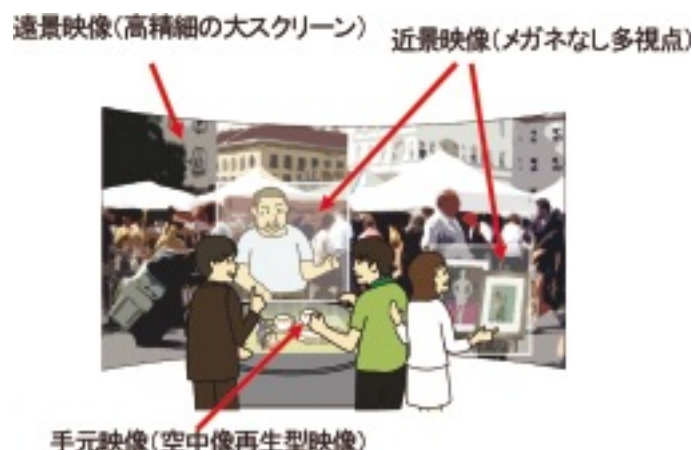
図2 超臨場感システムのプロトタイプ構成概念図
