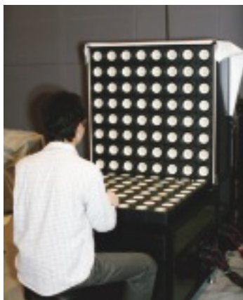
図3 独立128ch音響再生システムによる近接聴覚実験
