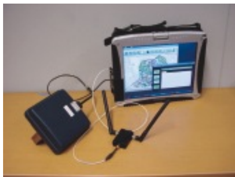
図3 ハイブリッドRFIDリーダライタユニット
