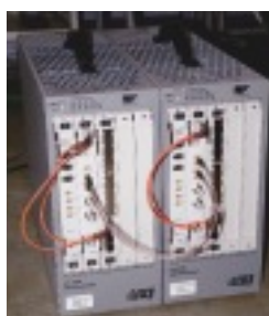
図7 レーダースプリアス高速計測装置の開発
