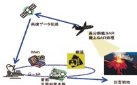
図2 災害時におけるSARデータの準実時間伝送の概念図
