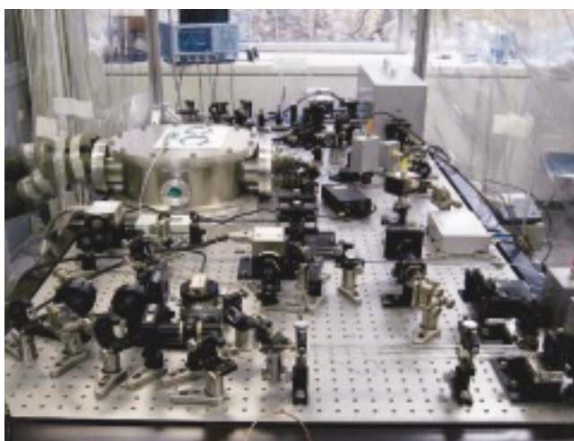
高性能全固体化TM, Ho: YLFレーザーの開発。 波長 2\mu\text{m} 、100mJ、20HzのQ-SW発振を達成
