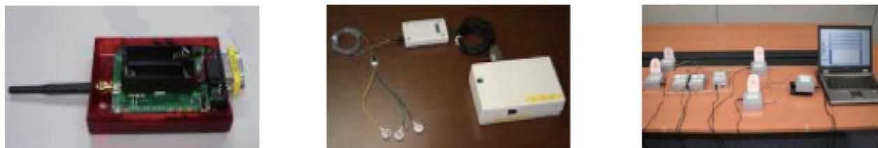
図2 要素技術に特化したBAN試作(左:Chirp-UWB-based BAN、中:ZigBee-based BAN、右:IR-UWB-based BAN)
