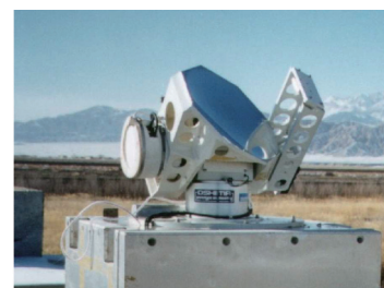
図7 NbN SIS受信機を搭載したサブミリ波電波望遠鏡
