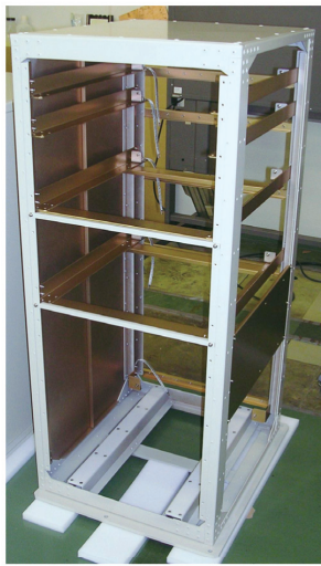
図2 機器搭載ラック(機内)
