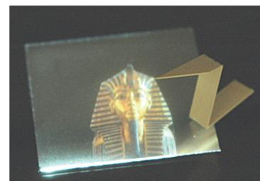
全く新しい微細構造による「鏡」である。この鏡は実物の反対側に「空中像」を結像するこれまでに無かった素子で、内側を反射面とする約100μ四方の微細な穴群(マイクロミラー・アレイ)から成っている。日本電計株式会社から販売中
