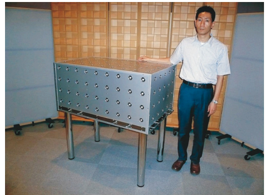
図4 試作した157チャンネルの異なる指向性をもつスピーカ
