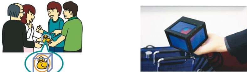
図3 箱型ディスプレイの概念図と本年度に開発した6面箱型ディスプレイ（gCubiK）
