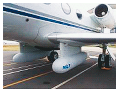
図2 航空機に搭載されたレーダのアンテナ部
