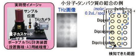
図 5 実時間・非標識生体物質検知システムと生体物質撮像例
