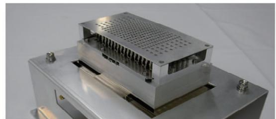
図8 航空機搭載ミリ波フェーズド・アレー・アンテナ
