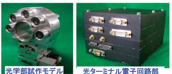
図10 50kg級小型衛星用小型光ターミナル試作モデル
