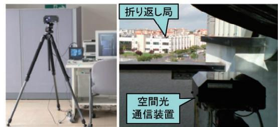
図7 超小型空間光通信装置
