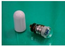
図 2(b) 信号減衰測定に使用したカプセル型信号発生器の試作品
