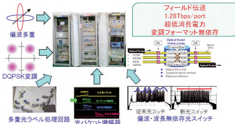
図 2 光パケットスイッチプロトタイプ
