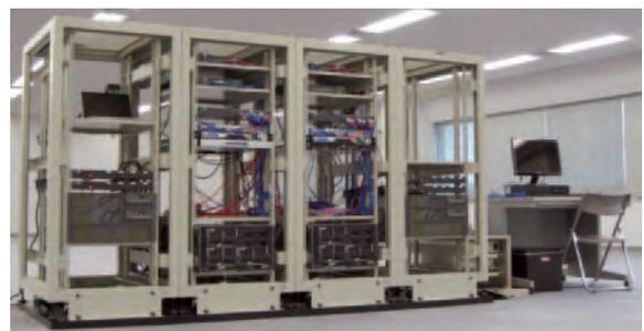
図 2 左：開発したヘテロジニアス型コグニティブ無線基地局、右：開発したコグニティブワイヤレスクラウド用サーバ
