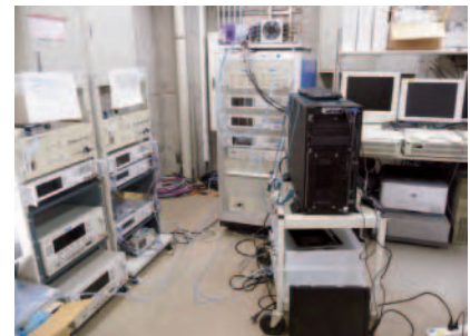
図 5 適応型デジタル中継器と対応する地球局装置を接続した総合試験環境の外観
