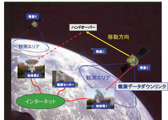
図10 UK-DMC衛星によるハンドオーバー実験
