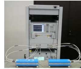
図3 整備した220GHzまでのデバイス特性計測システム
