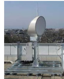
図4 GaN系HEMTを用いた屋外設置送受信機
