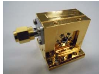
図 4 未来 ICT 研究所ナノ ICT 研究室と共同で開発した HEBM マウント
