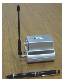
図 1 左 Wi-SUN 無線モジュール、右: 無線モジュールに電池ボックス、インタフェース部をつけた無線機
