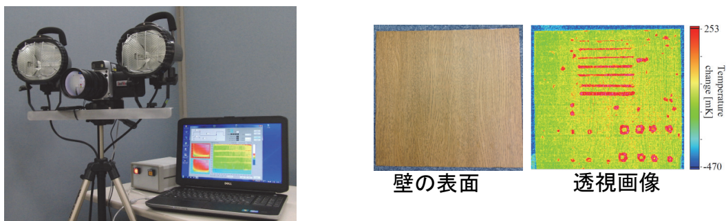
図3 2次元ロックインアンプによる赤外線診断システムとそれによる壁紙背後の傷の透視診断画像
